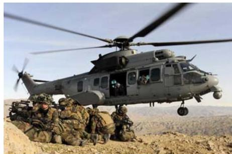
L'hélicoptère Caracal ne supporte pas la poussière. Ses turbines s'usent prématurément. Au Mali, quand les hélicoptères ne sont pas cloués au sol moteur cassé, ils ne peuvent pas voler à leurs performances maximales. Ils ne peuvent emporter que dix commandos à 200 Km alors que sa capacité maximale est de 28 commandos.
